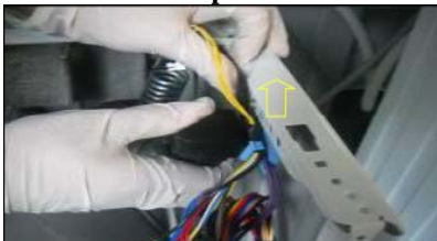
Démonter le pressostat EPS
