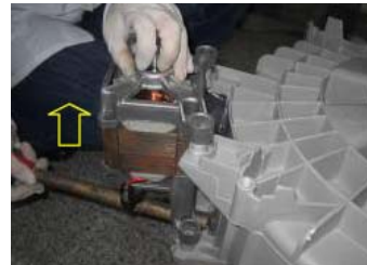
Démonter le moteur
