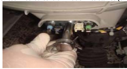
Démonter le collier joint de hublot
