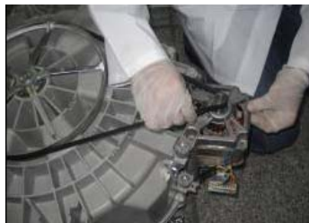
Dévisser les vis de fixation moteur
