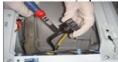
Enlever le collier du tuyau pressostat
