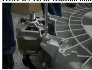
Dévisser les vis de fixation moteur
