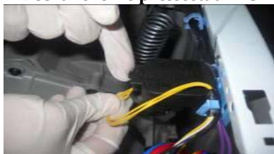
Débrancher le pressostat EPS
